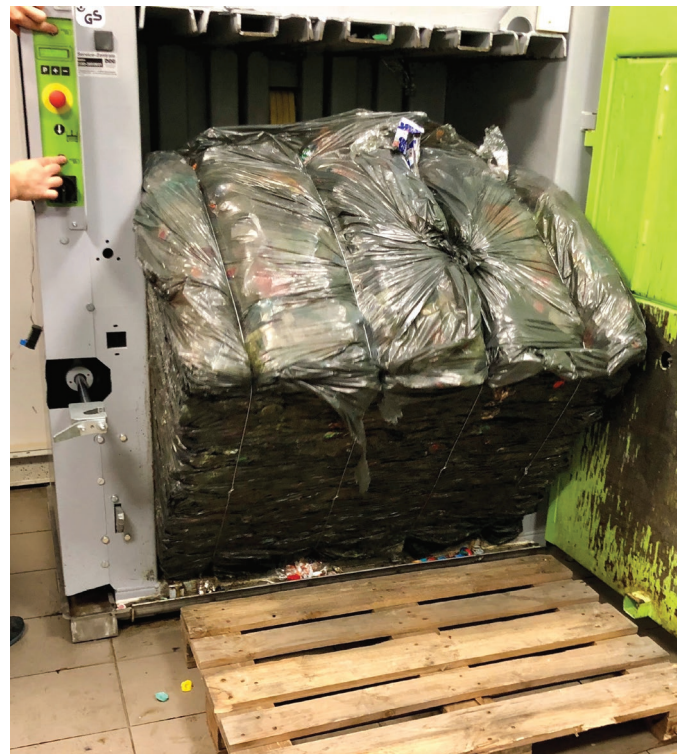
Einfacher Ballenauswurf durch hydraulischen Auswerfer
